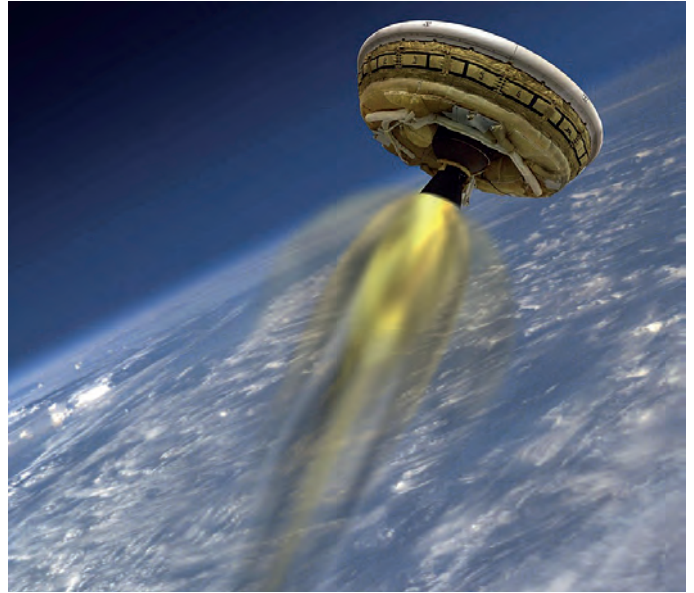
▲ После отделения от аэростатной подвески LDSD с помощью собственного твердотопливного двигателя Star 48 поднялся до высоты 55 км (так это выглядит в представлении художника).
